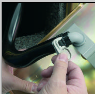
I.12 Výtokové koleno opäť nasadíme na obrubu, svorku vytiahneme, obrubu osadíme.
