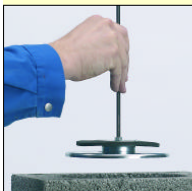
4.5 Ochranné viečko vyberieme pomocou vyhladzovacieho špáru s magnetom.
